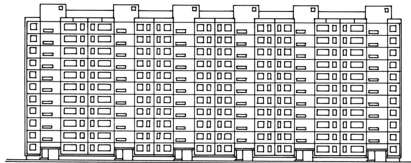
Rys. 2. Elewacja budynku 11-kondygnacyjnego WUF-T
