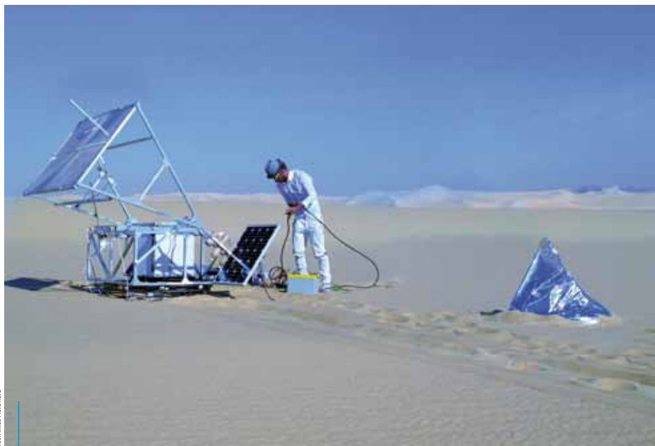
Maszyna do spiekania solarnego, 2011, projekt: Markus Kayser; Maszyna do spiekania solarnego, pustynia Sahara, Siwa, Egipt
