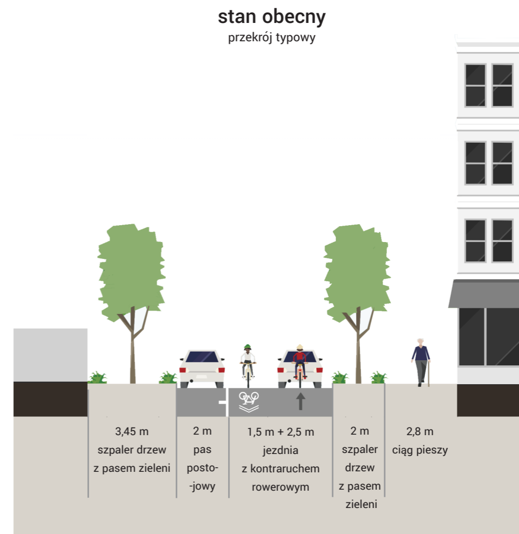
Ryc. 25. Ulica typu B na przykładzie ul. Paulińskiej - stan obecny źródło: opracowanie własne na podstawie Streetmix
