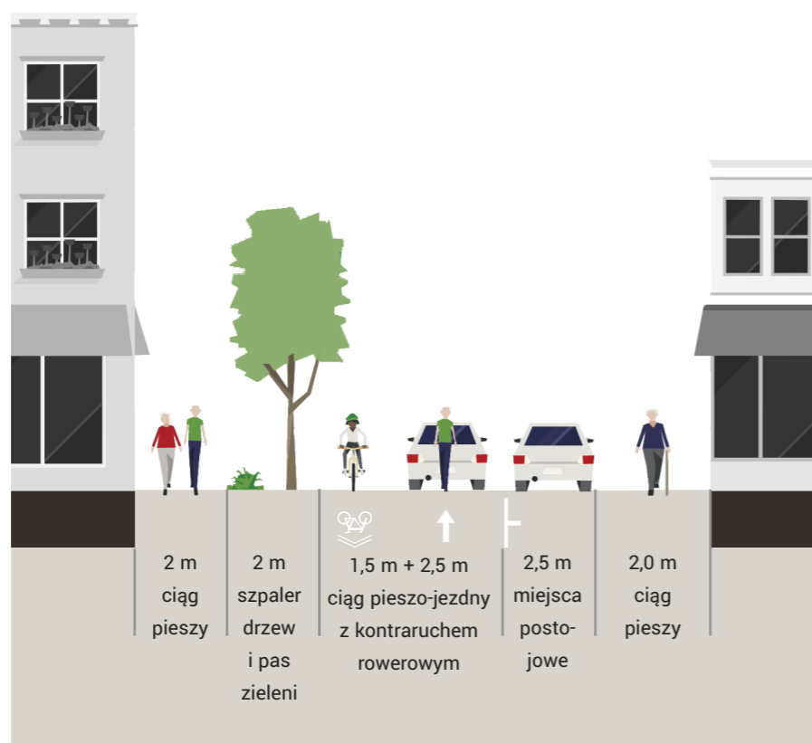
Ryc. 19. Ulica typu A na przykładzie ul. Józefa - stan docelowy źródło: opracowanie własne na podstawie Streetmix
