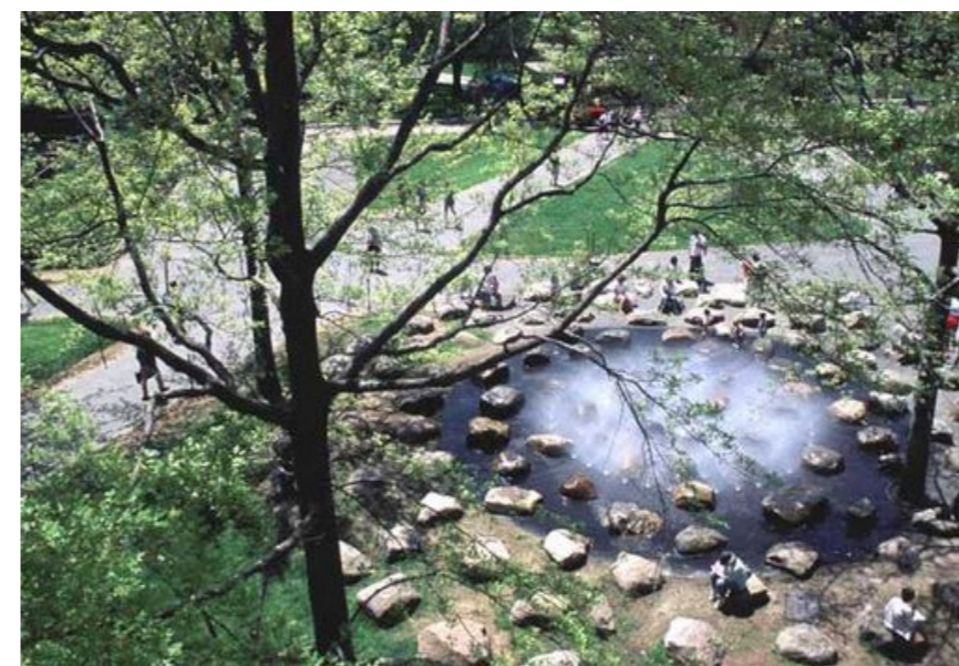
Ryc. 35. Zamgławiacze recyklujące wodę opadową poprawiające lokalny mikroklimat
