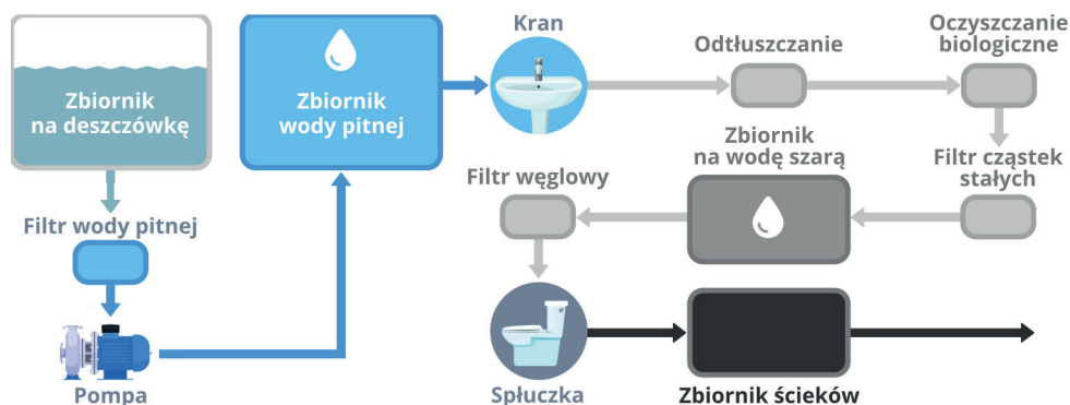
Rysunek 10: Schemat przykładowej instalacji wykorzystania wody deszczowej i szarej w budynku mieszkalnym
