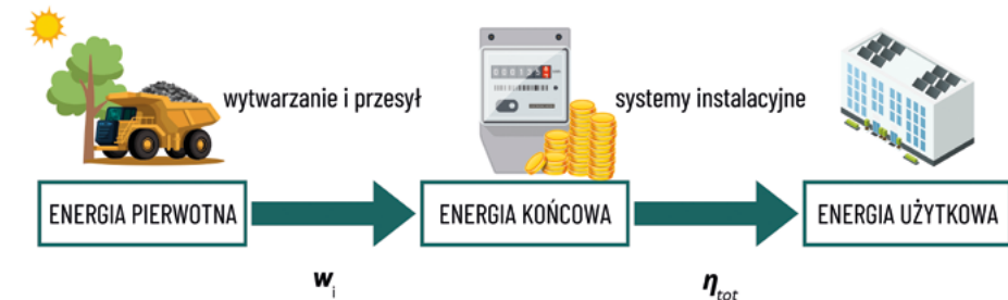
Rysunek 03-1 Schemat zależności pomiędzy energią pierwotną, końcową i użytkową. Źródło: opracowanie własne.
