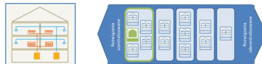
Rysunek 09-9 Jedna pompa ciepła do ogrzewania mieszkań, druga do przygotowania c.w.u. [1].
