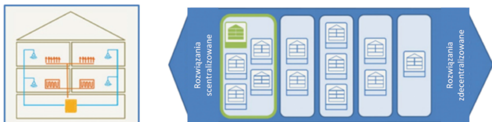
Rysunek 09-8 Jedna pompa ciepła do ogrzewania i przygotowania c.w.u. dla wszystkich mieszkań [1].
